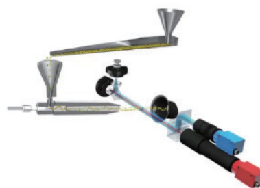
図 17-2 乾式測定 圧縮空気により凝集粒子を分散
