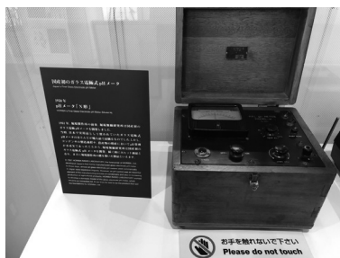
図 1 国産初ガラス電極式 pH メータの実物 (提供：HORIBA グループ)。
