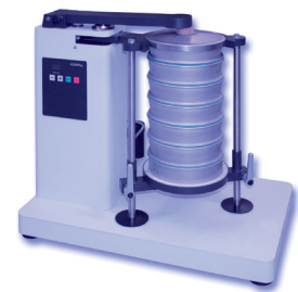
図5 タップ式ふるいの原理 写真3 タップ式ふるい
