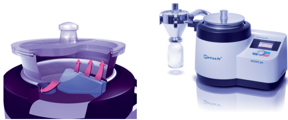
図6 エアジェット式ふるいの原理 写真4 エアジェット式ふるいの原理
