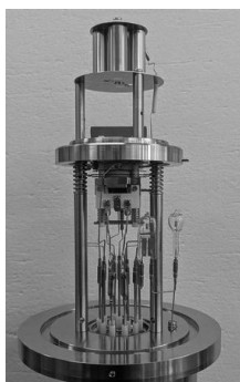
図2 実際の EI イオン源 (海洋研究開発機構 松井洋平様ご提供)
