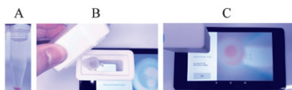
図8 3成分系均一液液抽出法とスマートデバイスによる六価クロムの高感度簡易分析
