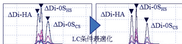
図3 LC条件最適化によるピーク分離改善例
