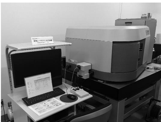
写真4 顕微レーザーラマン分光装置
