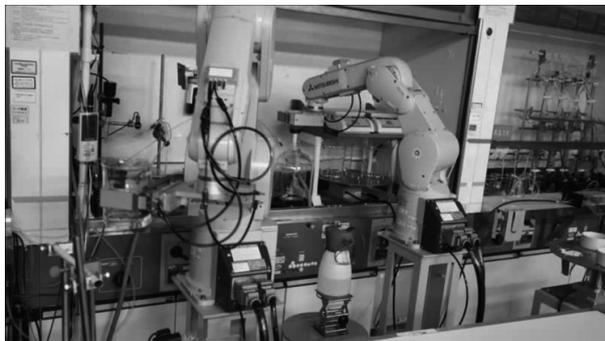
図4 沈殿生成と減圧濾過の自動化
