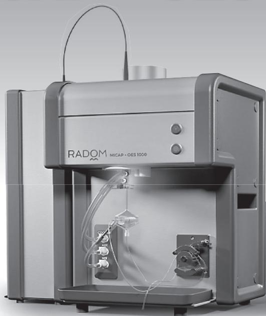
独自開発の高周波技術CERAWAVE™が可能にした窒素ガスベースのICP発光装置です。小型で高性能なMICAP-OES-1000は、独立したプラズマソースと光ファイバー接続のエシエル型分光光度計から構成されます。小型、軽量なこのシステムはユーザーに大幅なランニングコストの低減をもたらします。
