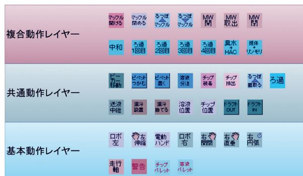
図 7 LabVIEW の制御 VI のレイヤー構成
