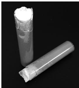
図 17 硬化開始判断したセメント外観
