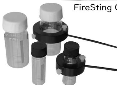
【センサー付きバイアル内部の酸素濃度を外側から測定可能】
