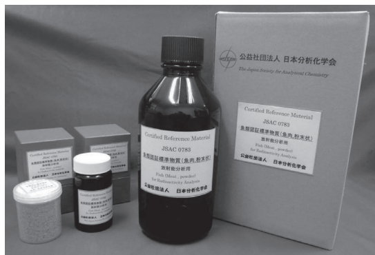
写真右 U8 容器(50 mm 高さ), 100 mL 容器, 1 L 容器に充填された魚肉認証標準物質
