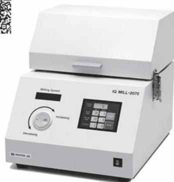
機器分析の試料前処理に最適。各種試料の粉碎・攪拌・分散に特化した卓上可搬型、且つ静音性に優れた粉碎装置です。
