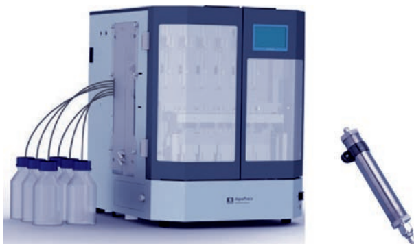
図 6 試料水ラインを PEEK に変更した全自動固相抽出装置と窒素ガス精製管
