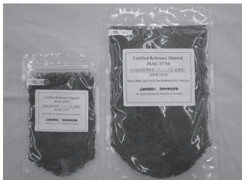
写真左 ポリエチレン袋に装填された牛肉認証標準物質
