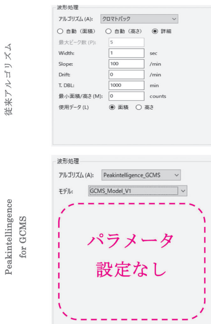
図 4 パラメータフリーな波形処理ソフトウェア Peakintelligence for GCMS
