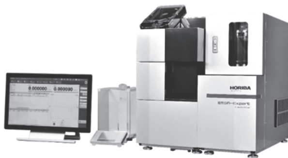
図4 酸素・窒素・水素分析装置 EMGA シリーズの外観
