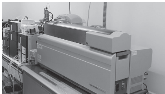
写真2 主力の質量分析装置（高感度分析（fmolオーダー）に長けており、ほぼ24時間毎日稼働している（左：6500QTRAP, 右：4000QTRAP） 左は今回研究室を案内していただいた伊藤助教
