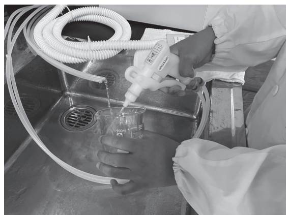
超純水を「泡立てずに容器に伝わせる」ことで、超純水を雰囲気汚染から防ぐ正しい方法で採水中
