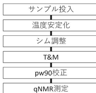
図3 NMRの相反定理を成立させるためのEC-qNMR測定手順
