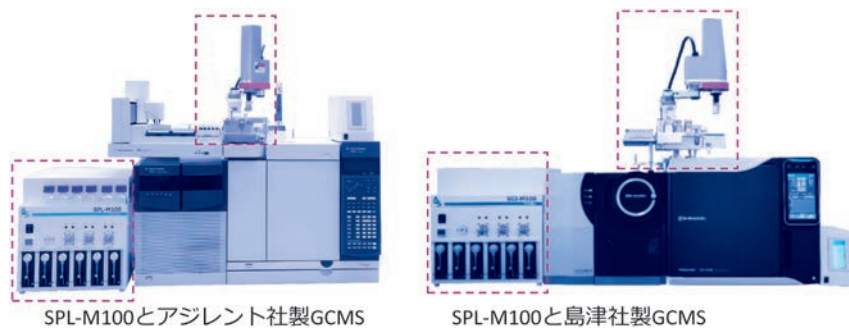
図4 オンライン固相誘導体化 SPE-GC/MS システム
