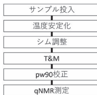
図3 NMRの相反定理を成立させるためのEC-qNMR測定手順 シム調整とT&Mは順番が逆になっても良い。
