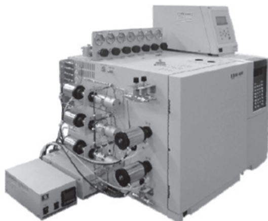
図1 アンモニア中不純物分析システムの外観
