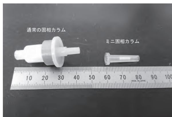
図 1 通常の固相カラム (Waters 社製) とミニ固相カラム (アイスティサイエンス社製) の比較
