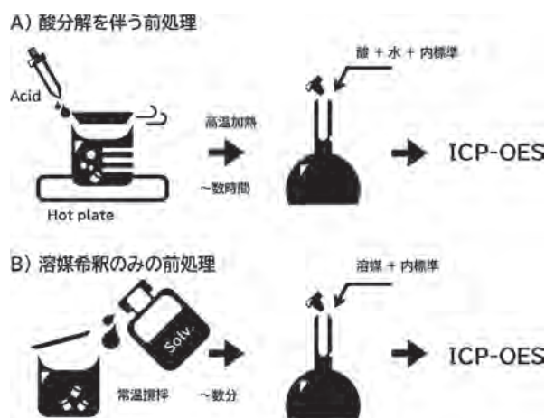
図 1 ICP-OES へ導入するための前処理
