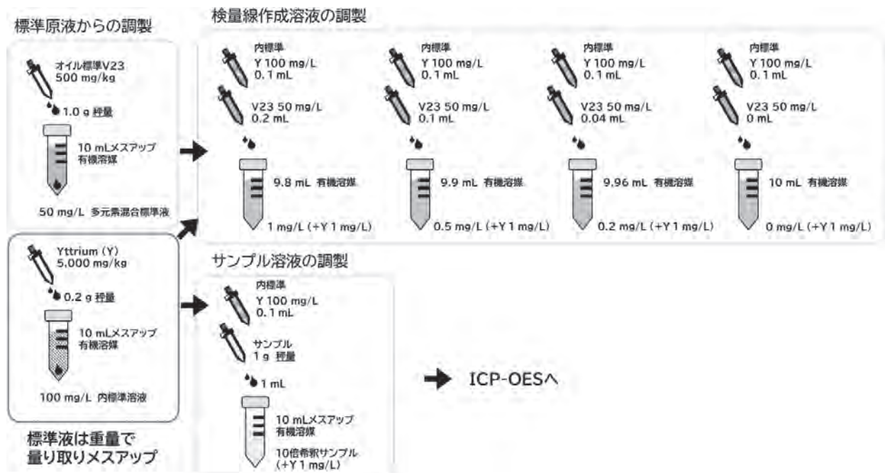
図5 オイルベース標準液を用いた標準液の調製手順例
