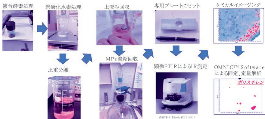
図3 筆者が行っている20 μm～5 mmまでのMPs分析方法の流れの概要図
