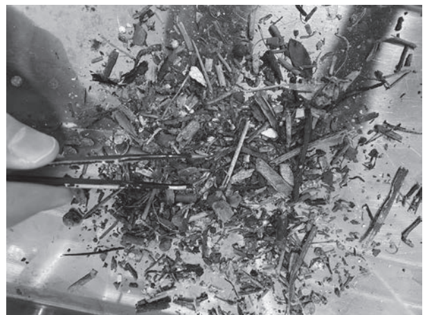
図2 プランクトンネットで捕集された大型の夾雑物質とマイクロプラスチック
