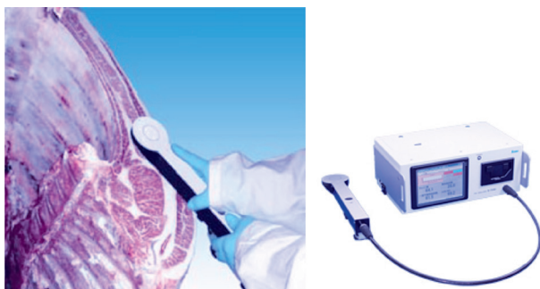
図2 近赤外分光を用いた牛肉脂肪の脂肪酸組成測定装置 (資料提供 (株)相馬光学, https://somaopt.co.jp/products/s7040/ )
