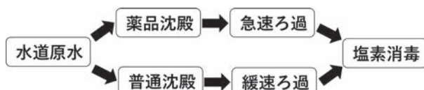
図1 上水道の処理プロセス
