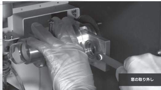
ICP発光分光分析装置の集光系メンテナンス
