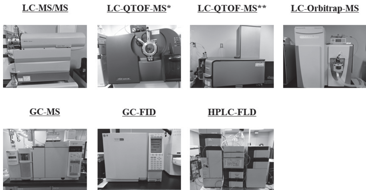
図1 本学法中毒部門で使用している機器 * : 主に定性分析に使用, ** : 主に定量分析に使用
