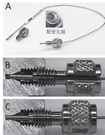
図4 MarvelX 配管とカラム管エンドフィッティングへの装着 A は MarvelX 配管と配管先端, B はカラム管エンドフィッティングに配管を装着する途中, C は装着終了。
