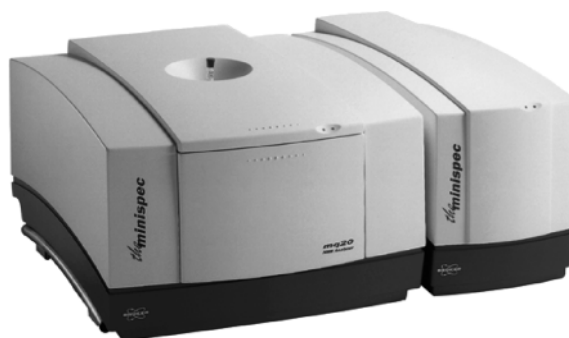
図 1 卓上型 TDNMR 装置（ブルカー社 minispec mq20） 左が磁石及びプローブを含むユニットであり、右が分光器ユニット。
