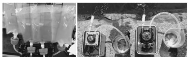
図3 (a) 密閉式のろ過装置 (b) 自動カートリッジ式フィルターろ過装置
