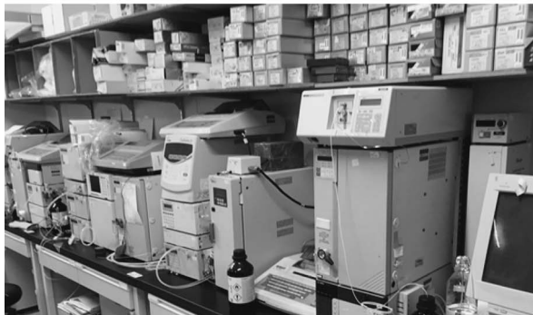
写真2 左上：MALDI-TOF-MS と松井先生，右上：LC-TOF-MS と田中先生，左下：ずらり並ぶ HPLC とカラム（オールインワン型ではなく，原理の理解しやすい従来の組み上げ式にこだわりを持っておられる），右下：年代物のメトラー社の天秤（メトラー社の社員でさえ見たことがない！天秤の原理の教育のためにいまだ現役で使われている）
