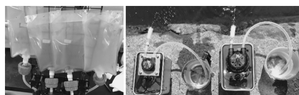
図3 (a) 密閉式のろ過装置 (b) 自動カートリッジ式フィルターろ過装置
