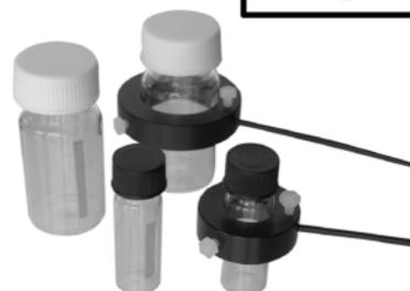
【センサー付きバイアル内部の酸素濃度を外側から測定可能】
