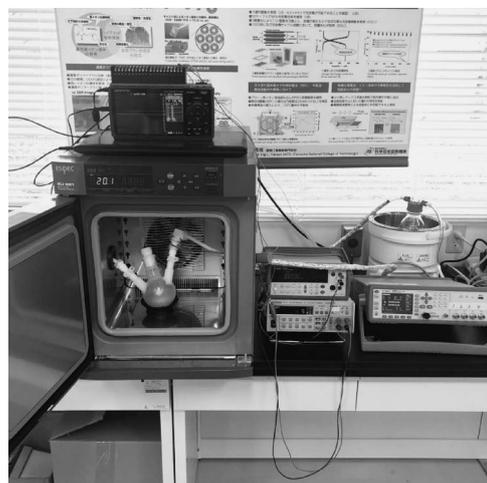
写真4 独自に設計・組み立てをした電気伝導率評価装置
