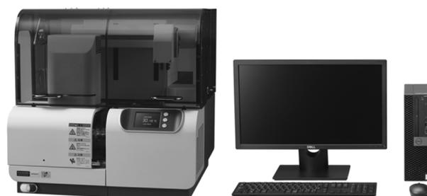
図 1 試料観察・示差熱熱重量同時測定システム
