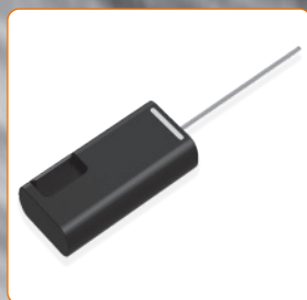
2. プローブ先端のキャピラリーにサンプルを塗布
