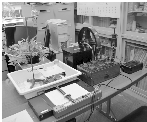
図1 ペンレコーダーと接続した初代ポーラログラフ装置
