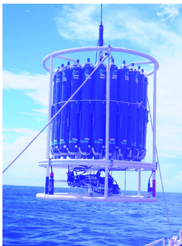
写真1 カローセル採水装置 エポキシ樹脂コーティングされたアルミニウム製フレームに 24 本のニスキン X 採水器が架けられている。下部に見える機械類は、塩分、水温、水深などを測定するセンサー (CTD) である。
