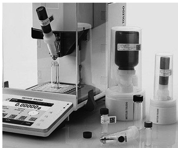
図 5 自動分注を可能としたシステムを備え持つマイクロ天秤
