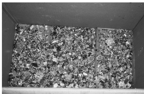
図5 粉碎後の電子基板の一例
