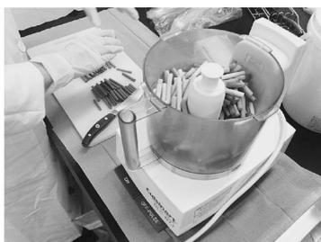
写真 2 粗く切った試料をフードプロセッサーに投入
