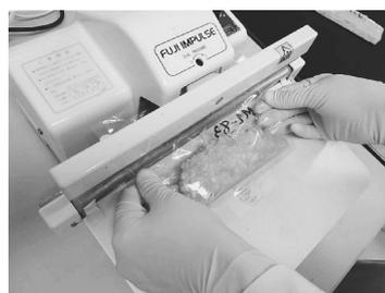
写真 4 ヒートシーラーで試料を封入
