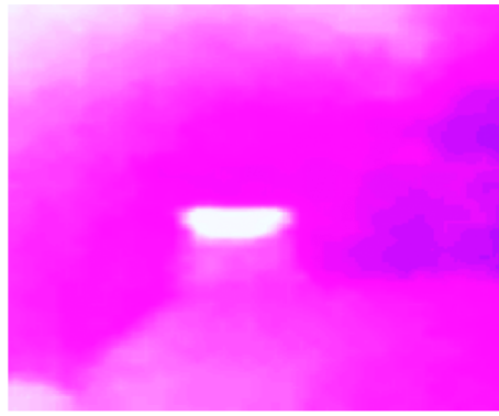
図1 焼却炉の炉内の通常の写真(右図)と開発中の水分量赤外イメージングで得られた炉内の水蒸気流出の様子(左図) 共に同じスケールで撮影したもの
