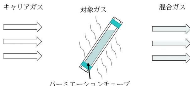
図 2 パーミエーションチューブ法の概略図
